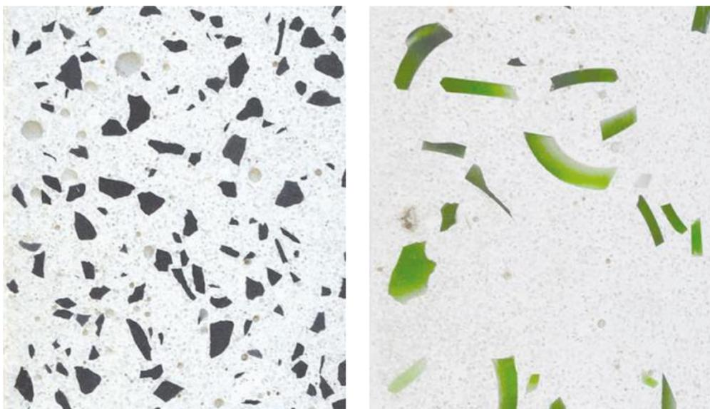
Componentes reciclados de diversos materiais são peneirados/triturados e adicionados à massa do tijolinho. Através da arrecadação de garrafas da comunidade do RJ, a linha Glass traz o vidro reciclado na composição do brick.
